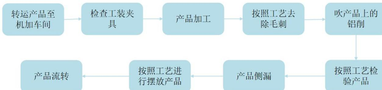
3、机加车间生产工艺流程（3）：
